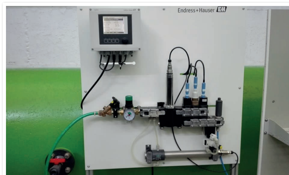
Abbildung 2: Sensorpanel mit Sensoren für Redox-Potenzial, Leitfähigkeit, Chlordioxid, Temperatur, pH-Wert und Trübung
